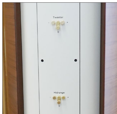
Die Rückseite mit den Anpassungsmöglichkeiten für Klang und Raum in Schritten von 1,5 Dezibel.
