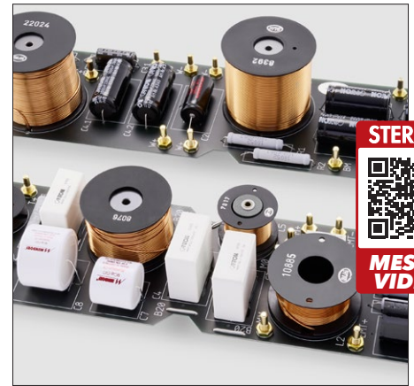
Die zweiteilige Frequenzweiche ist hochwertig bestückt und in rückseitiger Kammer isoliert.
