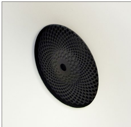
Der Hochtöner ist hinter dem Resonanzen unterdrückenden Gitter verborgen.
